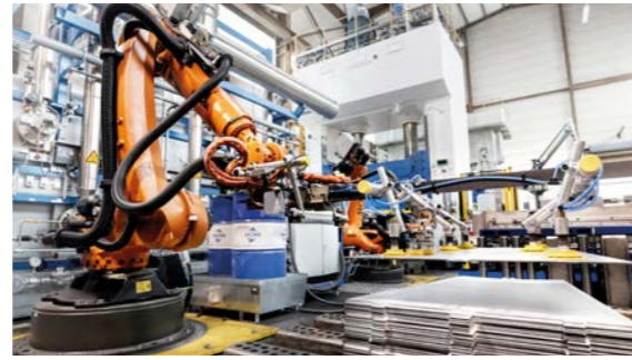
Schweißroboter im Einsatz
